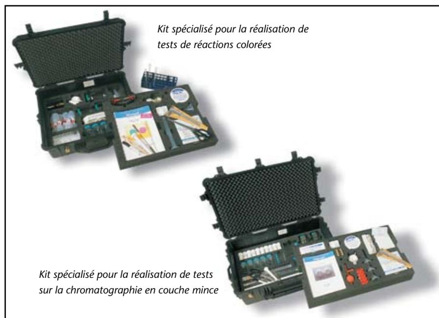
*Kit spécialisé pour la réalisation de tests de réactions colorées*
