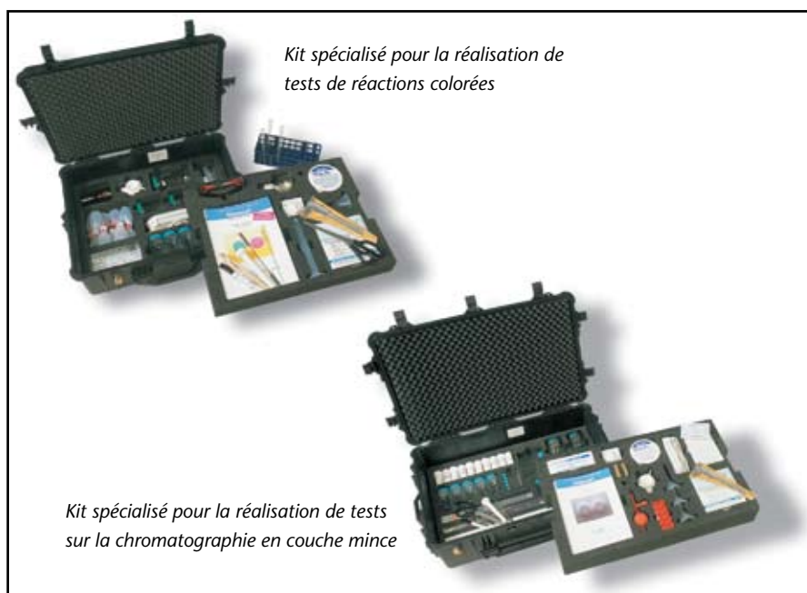
Coffrets GPHF-Minilabs contenant un équipement de laboratoire de base, des manuels et un ensemble complet de plus de quarante standards de référence secondaires.
